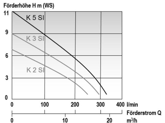
Q l/min, bei H m (Wassersäule), gültig für  $\rho = 1 \text{ kg/dm}^3$  und kinematische Viskosität  $\eta = 1 \text{ mm}^2/\text{s}$ . Förderwert- und Wirkungsgradgarantie nach DIN 1944. Genauigkeitsstufe III.
